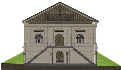
**Abb. 164** Querschnitt Eingangssituation Frauenempore 3D-Modell.jpeg
